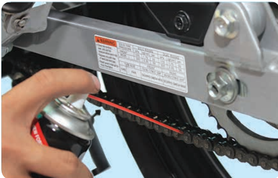
Gunakan minyak pelincir rantai. Kendur dan tegangkan pada kiraan 15 – 20 mm jarak bebas rantai. Tukar rantai sekiranya pemacu (sprocket) telah haus dan tajam.
